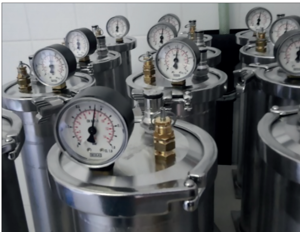
Versuchsgärungen in 2-Liter-Gärbehältern: Die Hefestämmen werden auf ihre Braueigenschaften hin untersucht. (Foto: TUM FZW BLQ)
