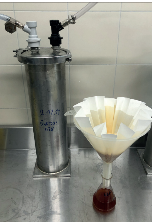
Versuchsgärung im Kleinform der Hefe Quercus – TUM 628 aus dem Projekt HefeJagd (Foto: TUM FZW BLQ)
