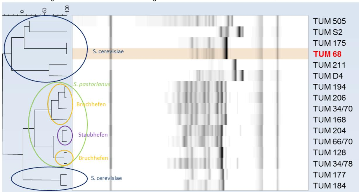
Virtuelles Gellaufbild eines kapillarelektrophoretisch aufgetrennten rDNA IGS2\_314 DNA Fingerprint des Hefestammes TUM 68 im Vergleich zu einer Auswahl der am häufigsten bestellten Hefestämme des FZW BLQ
